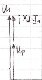
Polradspannung kleiner als Netzspannung  $\Rightarrow$
