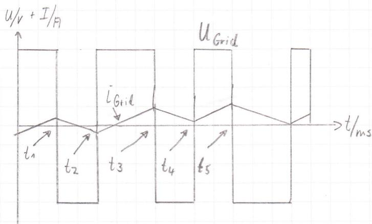
$$\Delta \bar{i}_{Grid} = \frac{U}{L} \cdot \Delta t \quad \left[ \frac{A}{\text{sec}} \cdot \Delta t \right]$$
